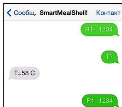
Рис.5. СМС сообщение со специальным кодом (для остановки процесса нагрева)
